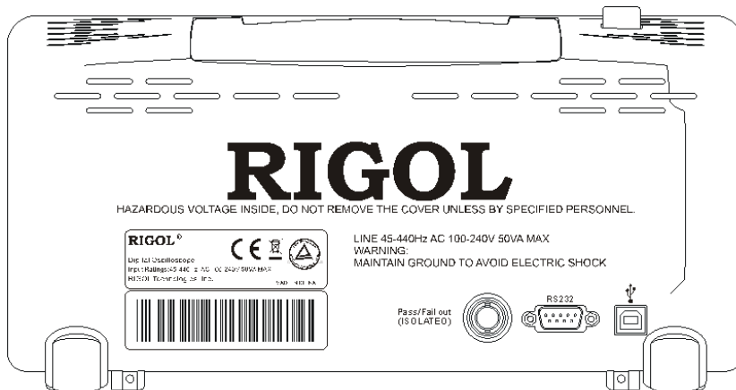
Abbildung 1- 3 Ansicht der Rückseite der Oszilloskop Serie DS1000E, DS1000D
